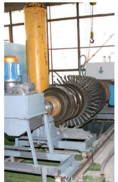
Комплекс устройств индукционного нагрева предназначен для термомеханических испытаний дисков турбин.
